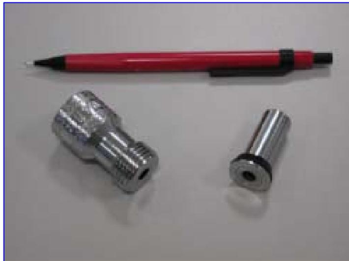
Fig. 6 Válvulas reguladoras de caudal
