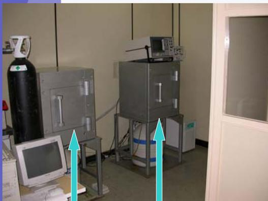
Espectrómetros gamma de alta resolución
